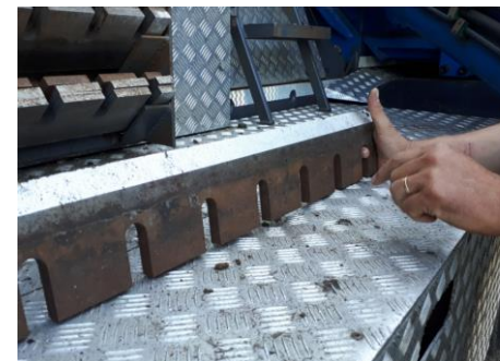
Rumpuhakkurin terät teroitetaan päivittäin.
